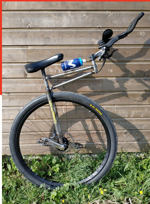
▲ Cadre acier sur mesure avec rallonge, prolongateurs et jante carbone
